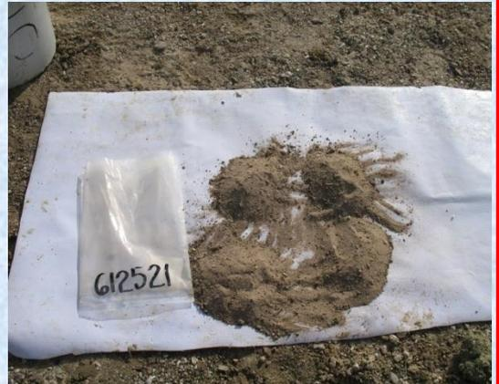
PRIMER PASO SE HACE UN POZO DE 5.00 M DE PROFUNDIDAD. UNA VEZ REALIZADO EL POZO DE EXPLORACIÓN, SE INTRODUCE UNA ESCALERA, PREVIAMENTE LIMPIADA; LUEGO SE REALIZARÁ LA LIMPIEZA DE UN CANAL DE MUESTREO METRO A METRO DE MANERA CONTINUA HASTA LLEGAR A LOS 5.0 M DE PROFUNDIDAD, EL CUAL TENDRÁ UN ANCHO DE 0.20 M. CADA MUESTRA SE CUARTEA Y SE GUARDA CERRANDOLA HERMÉTICAMENTE EN UNA BOLSA DE PLATICO ETIQUETADA, PARA SU ENVÍO AL LABORATORIO.
